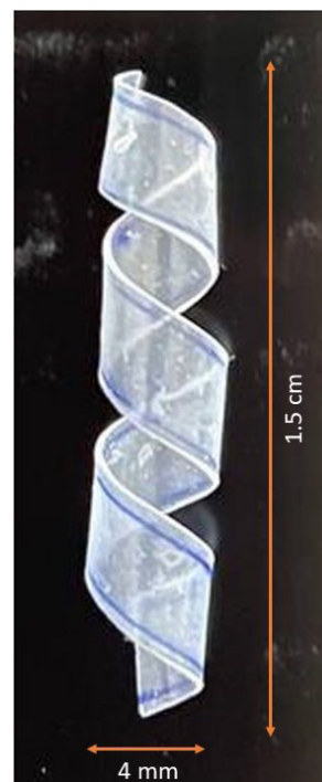
Fig. 1 : Dimension of Stent
